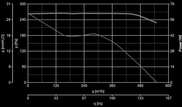
LINEO 150 - LINEO 150 T - MIN SPEED
