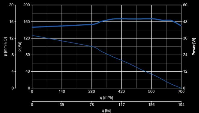
LINEO 250 Q - LINEO 250 Q T - MAX SPEED
